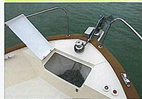
Comme souvent chez Rhéa, les appareils de mouillage sont bien soignés. La chaîne fait cependant du bruit en tapant dans le puits en navigation par mer formée.
