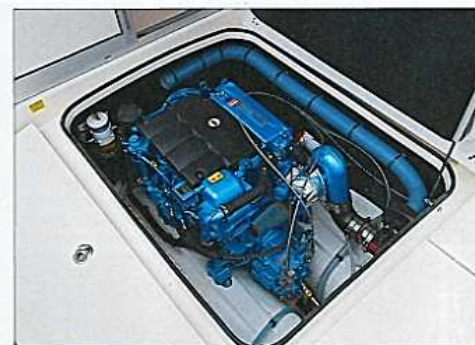
Le bloc Nanni issu d'une base Toyota est entouré d'une épaisse mousse pour l'insonorisation. Le niveau sonore a été bien réduit, mais il est encore perfectible.
