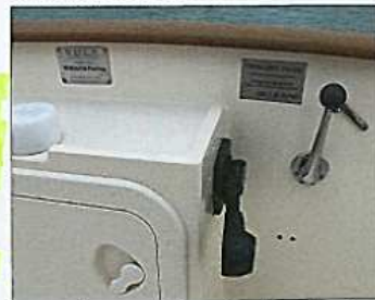
La commande extérieure de gaz et la trolling valve sont groupées près du point de montage de la barre franche.
