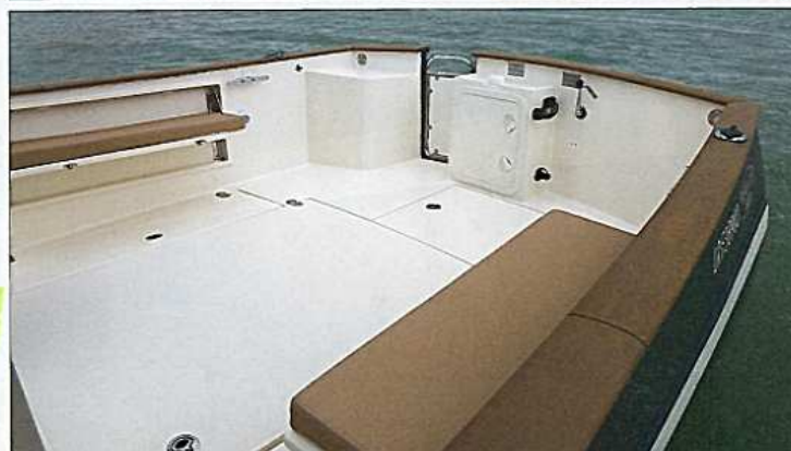
Contrairement au 750, les plats-bords sont en PVC et non en iroko. Quant aux bancs escamotables, ils sont très pratiques.
